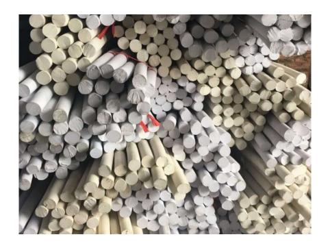
遇水胀大台座止浆条规范要恪守的,才华保证遇水胀大台座止浆条正常的施工的。小编咨询了一下相关的技术人员,他们给出了具体的规范,一般的规范有下面这些的:台座止浆条拆除混凝土模板后,凿毛施工缝,用钢丝刷铲除界面上的浮碴,并涂2□5mm厚的水泥浆,待其表面干燥后,用配套的胶粘剂或水泥钉固定遇水胀大台座止浆条,再浇注下一环混凝土。台座止浆条接头处应该怎么接才更稳固?遇水胀大台座止浆条接头处应重叠搭接后再粘接固定,沿施工缝构成闭合环路,其间不得留断点。遇水胀大台座止浆条定位后至浇注下一环混凝土前,尽量避免被水浸泡,必要时加涂缓膨剂,避免其提前胀大。振捣混凝土时,振捣棒不得触摸遇水胀大台座止浆条。档头板制作时应考虑预留装置遇水胀大台座止浆条的浅槽。水工建筑物每隔一定距离必须设置伸缩缝予以分开,建筑物因地基不均匀沉降而产生裂缝。
